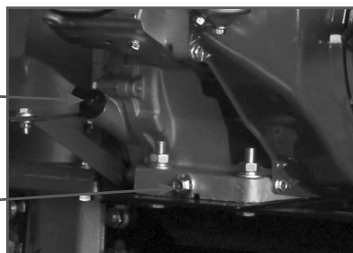
Рис. 10 Проверка уровня масла в картере
