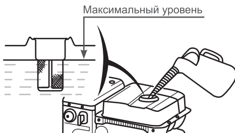
Рис. 8 Максимальный уровень топлива в топливном баке
